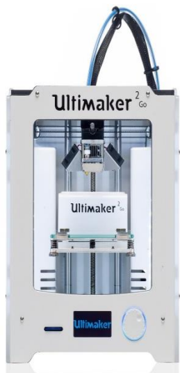
3D принтер Ultimaker 2 (Нидерланды) Рабочая область, мм: 223×223×205 Толщина слоя: 50–250 мкм Скорость печати: до 300мм/с
