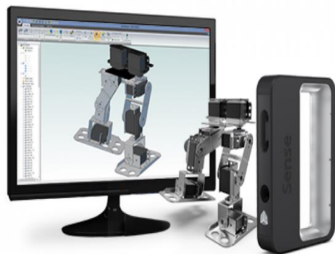
3D-сканер Sense Точность: 0,9-1 мм
