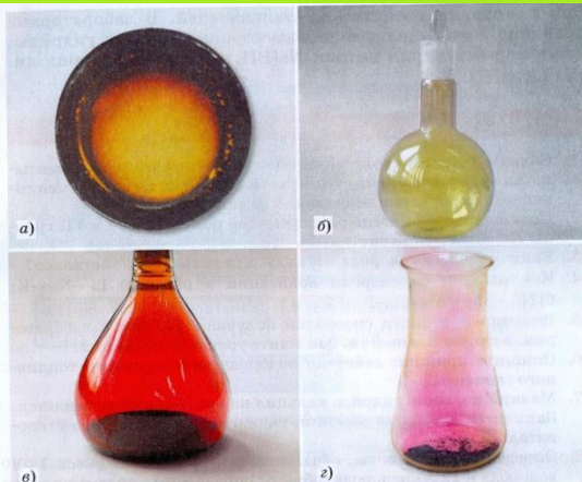
Рис. 3. Галогены: разрез трубы, заполненный фтором (а); колбы с хлором (б), бромом (в), иодом (г)
