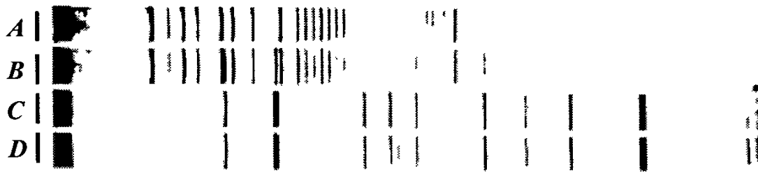
Рис 2 10 Рентгенограммы, полученные в камере Гинье A – аммониевые квасцы \text{NH}_4\text{Al}(\text{SO}_4)_2 ; B – квасцы + кварц C и D – кварц
