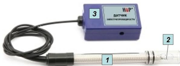
**Рис. 4.** Датчик электропроводности.
