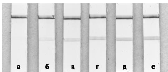
Рис. 3. Результаты определения стандартных растворов с-БСЖК, нг/мл: а – 0; б – 5; в – 10; г – 20; д – 50; е – 100
